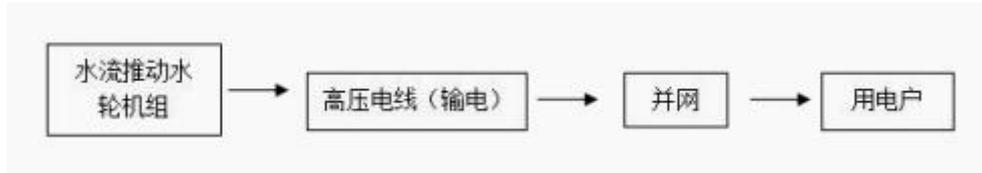
图 2-3 项目产生电力流程图
